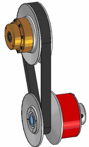
**Settore di applicazione:** Variatore di velocità adatto per motori sino a 80 Hp (60 KW). Le due pulegge hanno il meccanismo di funzionamento a tenuta stagna lubrificato con grasso, per questo motivo garantiscono una durata del gruppo pari a 50.000 Km. La cinghia consigliata è di tipo trapezoidale 36 x 14 x 1113 con interasse 320 mm (Dayco)
